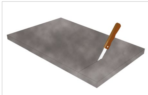
Absorber auf erforderliche Größe zuschneiden
