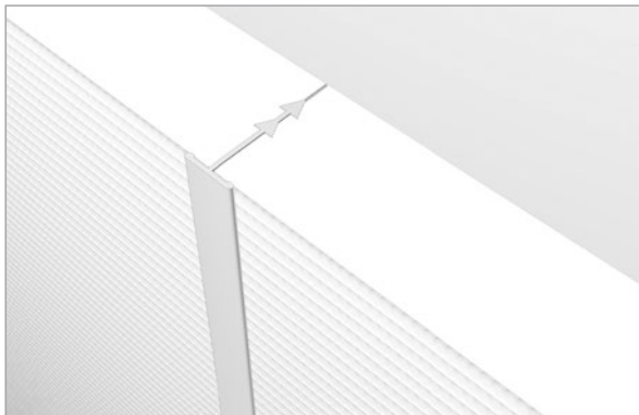
Plattenstoß mit T-Profil
